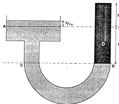
ب) در این حالت که بالای ظرف استوانه‌ای بسته است، با ریختن آب در لوله سطح جیوه در ظرف استوانه‌ای به اندازه‌ی  $x$  بالا می‌رود.
