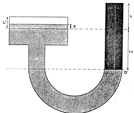
با فرض اینکه هوا در داخل ظرف یک گاز کامل است می‌توان فشار هوا در بالای ظرف را بدست آورد. فشار اولیه‌ی هوا، فشار جو است که برابر  $75 \text{ cmHg}$  است. با فرض دمای ثابت برای هوا در بالای ظرف داریم:
