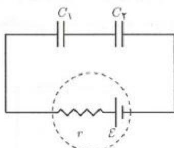
در مدار نشان داده شده در شکل  $E$ ،  $r$  و  $C_1$  مقادیر ثابتی هستند. با تغییر  $C_2$  انرژی ذخیره شده در خازن ۲، که آن را با  $U_2$  نشان می‌دهیم، تغییر می‌کند. نمودار  $U_2$  بر حسب  $C_2$  کدام است؟
